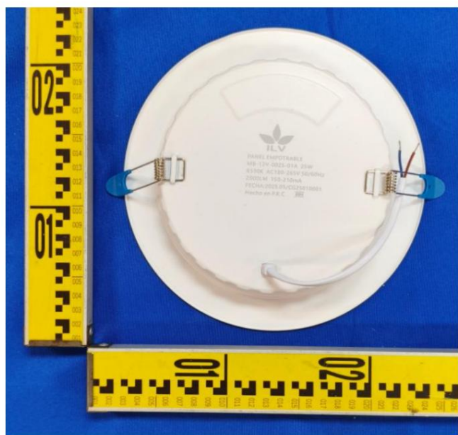
Imagen 2.: Vista general del MB-13V-0025-01A
